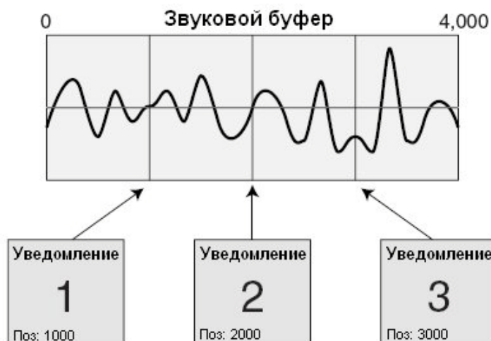
Рис. 4.10. Уведомления могут быть размещены (путем указания смещения) в любом месте внутри звукового буфера
