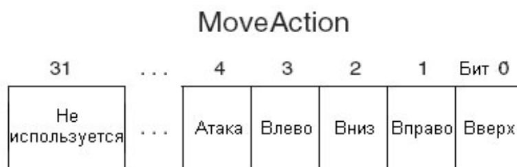
Рис. 15.16. Каждый разряд в переменной MoveAction используется для определения конкретного действия
