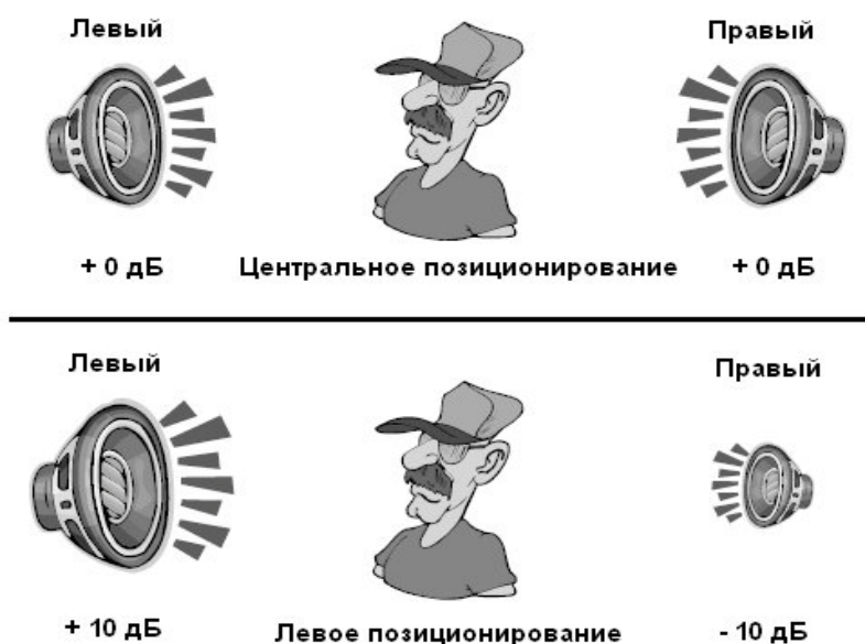
Рис. 4.8. Обычно динамики воспроизводят звук с одинаковой громкостью (измеряемой в децибелах, или, для краткости, дБ). Позиционирование уменьшает громкость в одном из динамиков и увеличивает в другом, что приводит к возникновению псевдо-трехмерных эффектов
