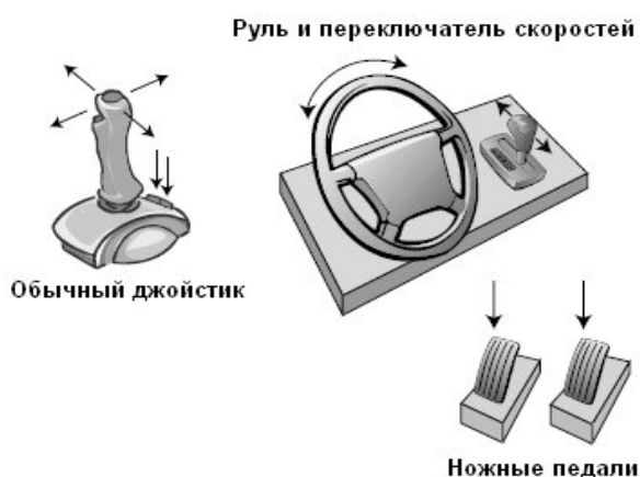
Рис. 3.3. Задающие направление, поворачивающиеся и нажимаемые приспособления для управления — вот общие черты джойстиков, независимо от их внешнего вида
