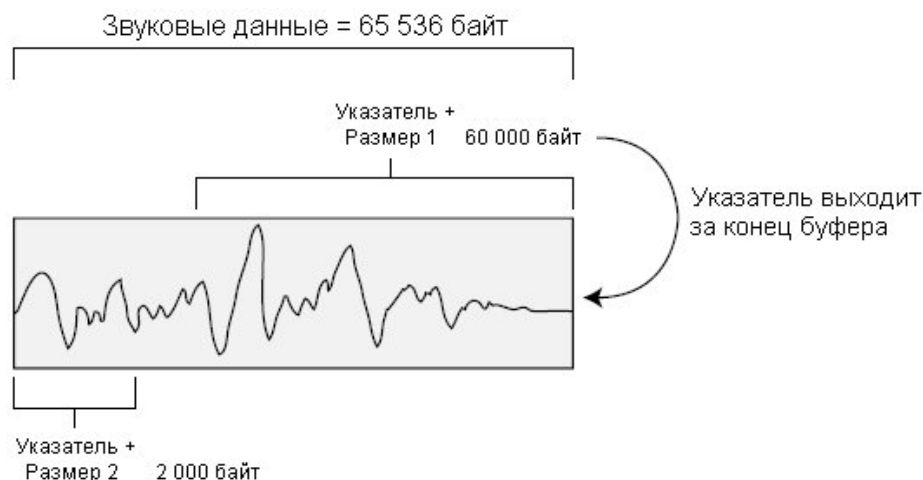
Рис. 4.7. Буфер данных, размером 65536 байт, в котором блокируются для доступа 62000 байт. Первый указатель используется для доступа к 60000 байт, а второй указатель — для доступа к оставшимся 2000 байт
