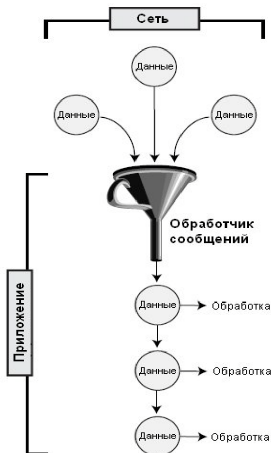
Рис. 5.9. Сетевой объект получает сообщения из сети и позволяет обработчику сообщений обрабатывать их одно за другим
