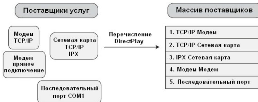
Рис. 5.8. Перечисление создает список поставщиков услуг системы и помещает его в легкодоступный массив поставщиков
